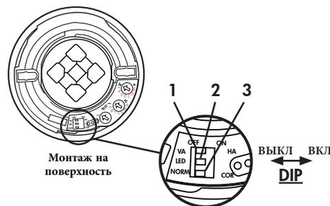
DIP 1 Автоматический/полуавтоматический режим
