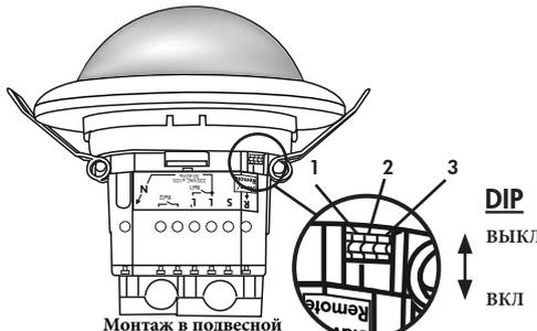
DIP 1 Автоматический/полуавтоматический режим
