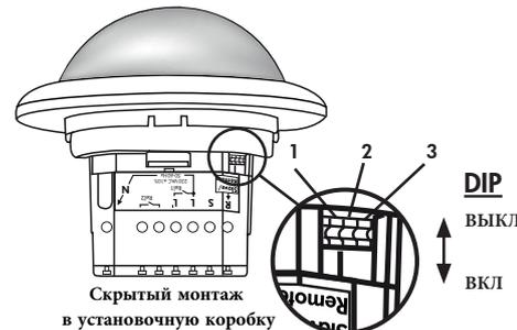
DIP 1 Автоматический/полуавтоматический режим
