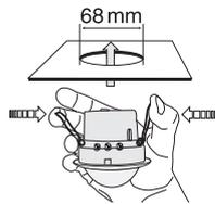
Подключите провода в соответствии со схемами подключения и вставьте датчик в отверстие, как показано на рисунке. Зафиксируйте его с помощью пружинного зажима.
