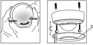
Датчик устанавливается на твердой и ровной поверхности. Перед установкой необходимо снять круглую линзу (C) для PD4-KNX или крышку-кольцо (D) для PD2-KNX (поверните против часовой стрелки).
