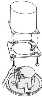
Датчик может быть установлен в монтажную коробку, установленную на потолке. Возьмите монтажную пластину. Прикрепите пластину к монтажной коробке 2-мя или 4-мя винтами. Убедитесь, что монтажная пластина закреплена плотно и не болтается. Подключите провода к датчику в соответствии со схемами подключения. Установите датчик в монтажную коробку с пластиной как, это показано на рисунке, пружинные зажимы закрепят датчик в коробке.
