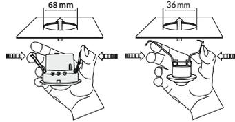
Датчик был спроектирован и разработан специально для установки в подвесные потолки. Круглое отверстие диаметром 68 мм (PD2 / PD4-KNX) соответственно. 36 мм (PD9-KNX).
